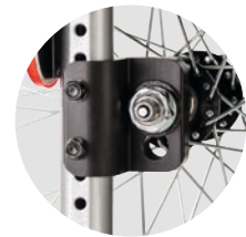
Radstandsverlängerung durch Drehen des Varioblocks nach hinten
